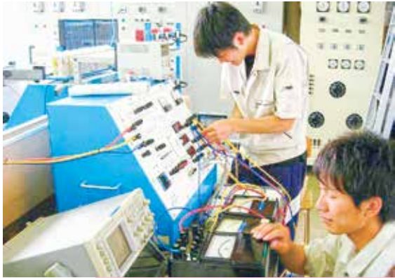
インバータによる三相モータの負荷試験
