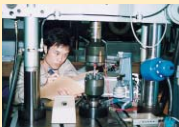
引張り圧縮疲労試験 Serbopulser
