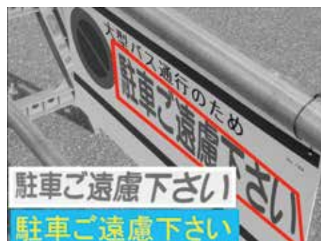
情景文字認識システムの処理例 (オムロンソフトウェア株式会社との共同研究) A system for recognizing characters in scene images (Joint research project with Omron Software Co., Ltd.)
