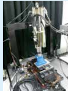
画像処理による砥粒切れ刃3次元計測装置 Three-Dimensional Measurement of Wheel Surface with Image Processing
