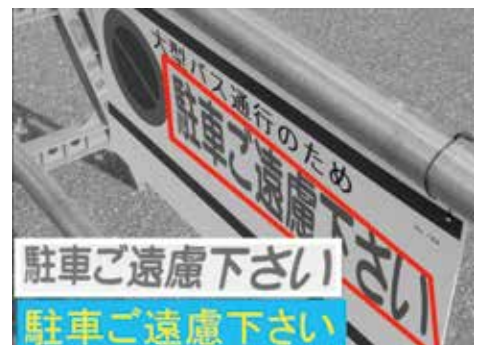
情景文字認識システムの処理例 (オムロンソフトウェア株式会社との共同研究) A system for recognizing characters in scene images (Joint research project with Omron Software Co., Ltd.)
