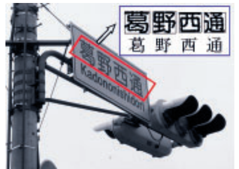
情景文字認識システムの処理例 a system for recognizing characters in scene images (オムロンソフトウェア株式会社との共同研究) (a joint research project with ©OmronSoftware)
