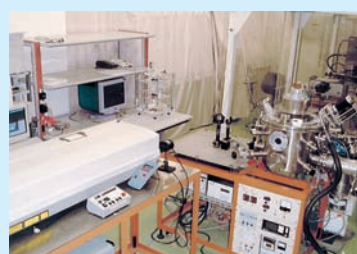
パルスレーザデポジション(PLD)システム Pulsed Laser Deposition (PLD) System
