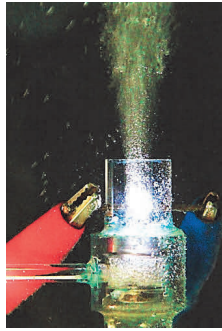
図1 マイクロバブルへのパルス放電の様子
