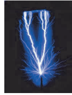
図 1. 二酸化炭素-水混合液中のパルス放電の様子
