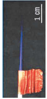
図 2. 大気圧パルス放電プラズマジェットの様子
