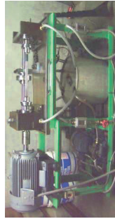
図1 FZG動力循環式歯車運転試験機
