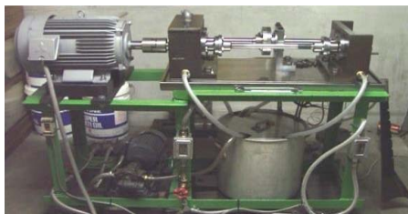
図1 FZG動力循環式歯車運転試験機
