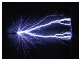
図 1. 二酸化炭素-水混合液中でのパルス放電の様子
